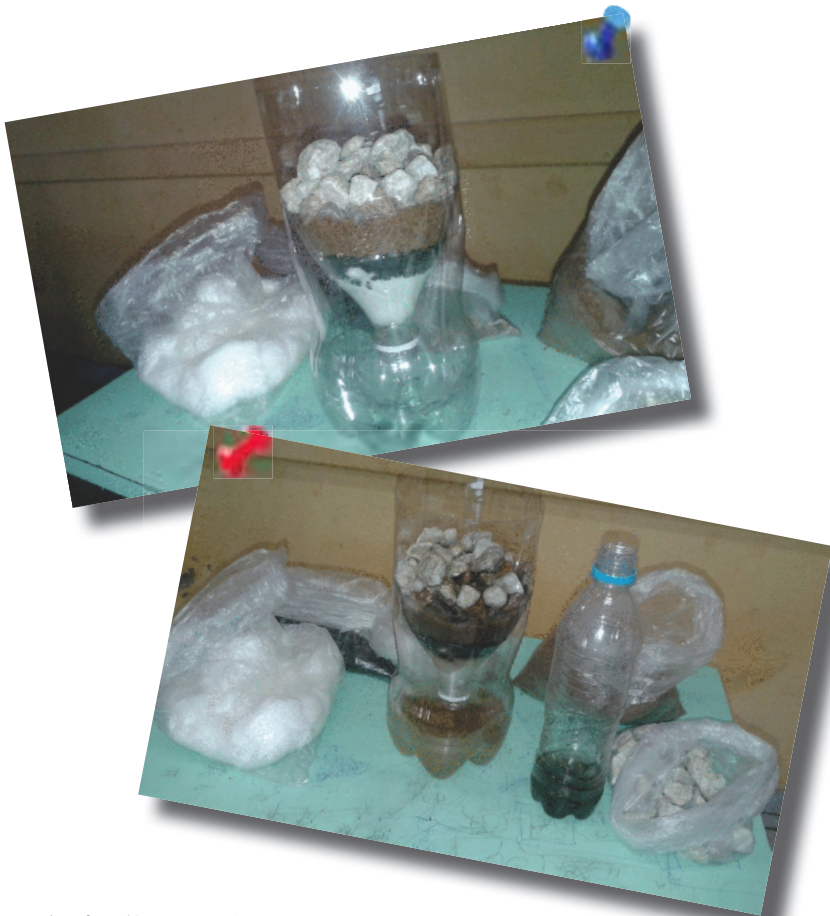
Figuras 1 e 2: Filtragens da água
